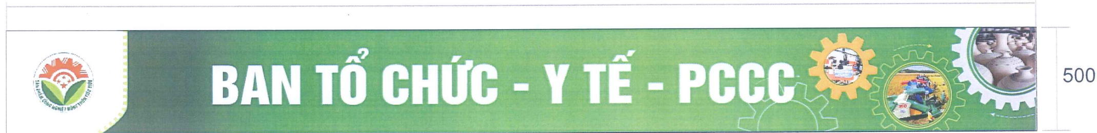
PANO BIÊN TÊN KHU VỰC BAN TỔ CHỨC KT: 500 X 5.000 SỐ LƯỢNG: 1 TẤM DIỆN TÍCH: 2,5M2 CHẤT LIỆU: BẠT HIFLEX ĐÉ GHI KHUNG SẮT: 20MM X 20MM X 1,3MM (DÀY) TRANG THIẾT BỊ ĐI KÈM: BALET, THẨM, 01 BÀN, 02 GHẾ, 01 BÓNG TUÝP, 01 Ổ CẮM
